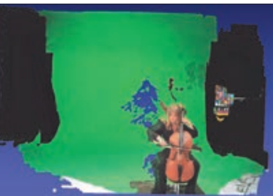
3D-Rekonstruktion basierend auf einem Lichtfeld
