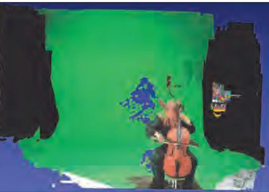
3D-Rekonstruktion basierend auf einem Lichtfeld
