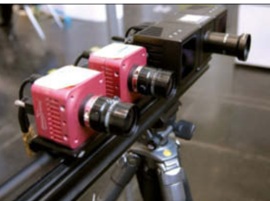
Sensor Fusion verbindet ein Kamerapaar mit der Time-of-Flight-Technologie (ToF) [oben/unten].
