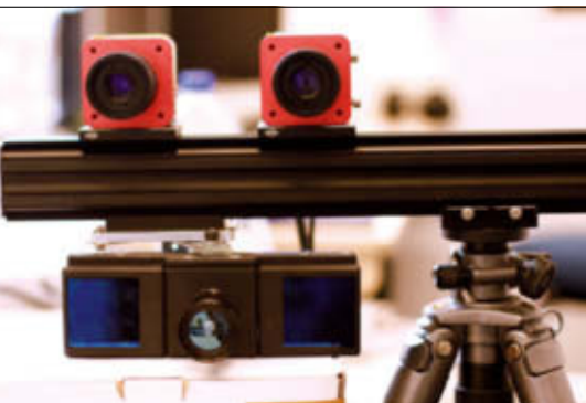
Sensor Fusion verbindet ein Kamerapaar mit der Time-of-Flight-Technologie (ToF) [oben/unten].
